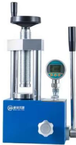
图 9-2 冷压机示意图
