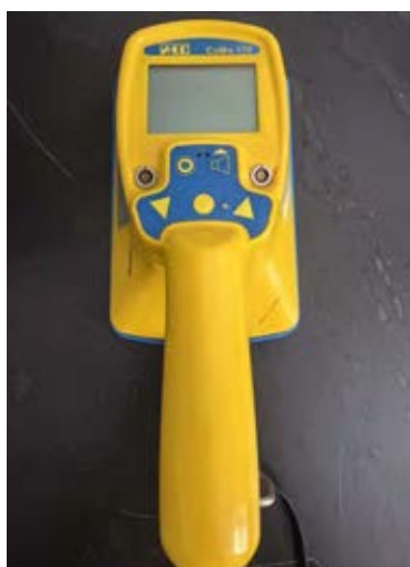
图 5.2-38 表面污染测量仪
